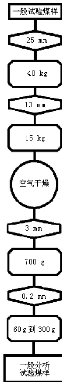
图 10 一般分析试验煤样制备程序示例
